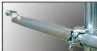
A partir de la composición 4 se suministra un dispositivo de anclaje al muro, de distancia regulable. Viene realizado mediante tubo de acero cincado, provisto de pivote orientable, de enganche por Ø 8 mm, para anclar a la pared, unidos al andamio con brida ortogonal de doble pinza.
