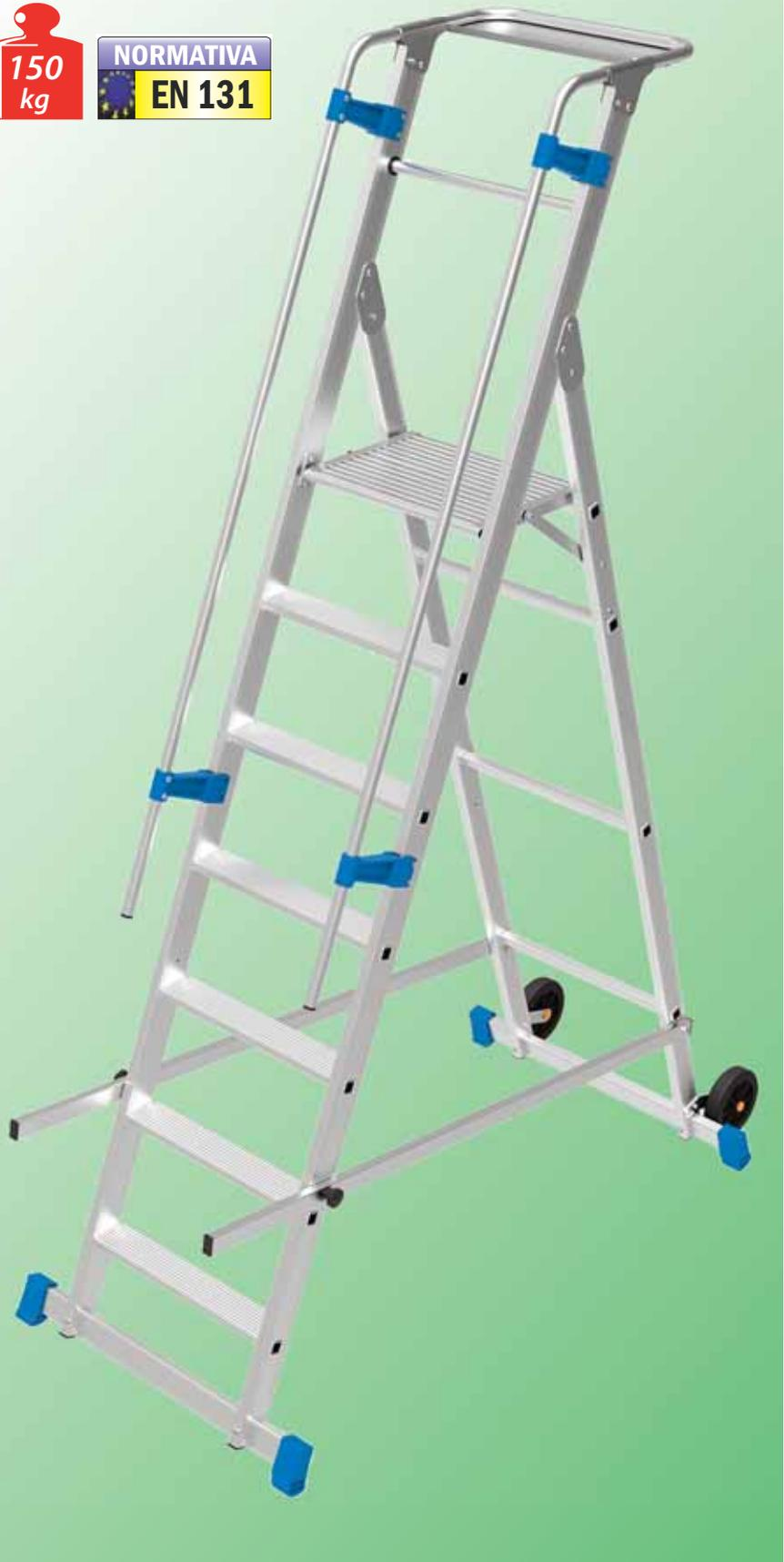
Completamente de aluminio, con estructura desplegable en tijera. Montantes paralelos de 73 x 25 mm. de sección y peldaños anchos de 80 mm. soldados a la estructura con el sistema Tig.
