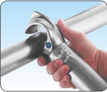
**Barras horizontales y diagonales de enganche rápido y bloqueo automático.** Con gatillo de seguridad que impide el desensamblado accidental, para un montaje simple, rápido y seguro.
