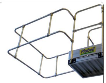
Jaula protectora colocada en voladizo, de tamaño 135 x 135 cm. completamente desmontable, plataforma de trabajo posicionada en voladizo de dimensiones 77 x 60 cm. con superficie anti- deslizante y provista de salva pies de aluminio de 15 cm. de alto.
